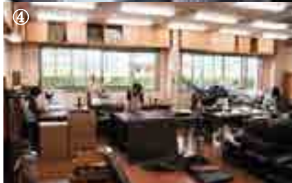
①社内には膨大な自社製造のサンプルファイルがストックされ、過去のデザインやノウハウを目に見える形で蓄積している。②20 台の織機が並ぶ工場内観。主に高品質ネクタイの生地が織られている。③紋意匠と呼ばれる、生地デザインを実際に織機で織れるよう組織をデータ化する作業。④検反作業風景。丁寧に生地をチェックしていく。⑤代表取締役の川村昌洋さん（中央）紋意匠室長の川村英之さん（左）営業部長の川村武史さん（右）。
