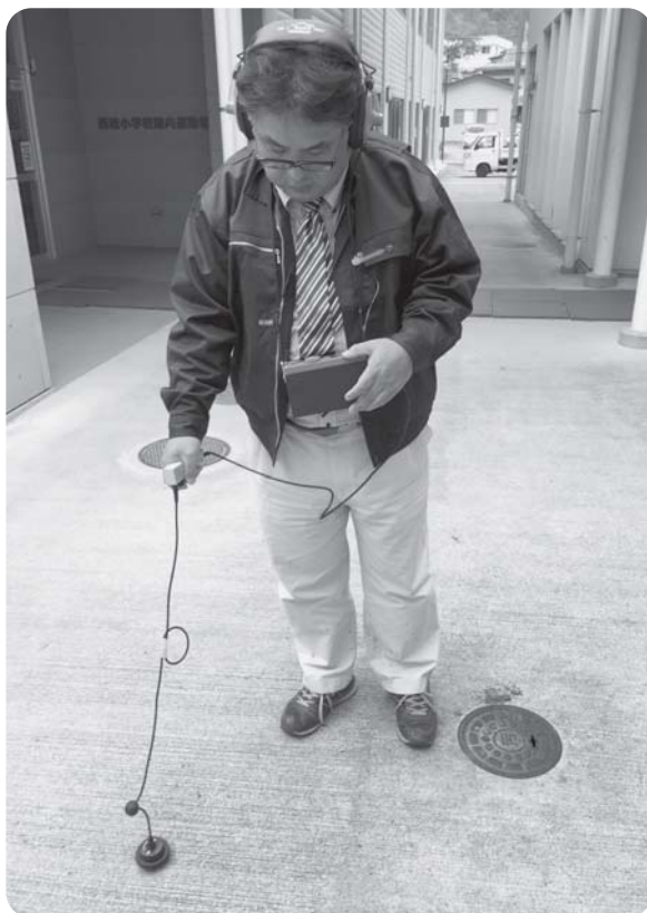
漏水探知機を使った漏水調査
